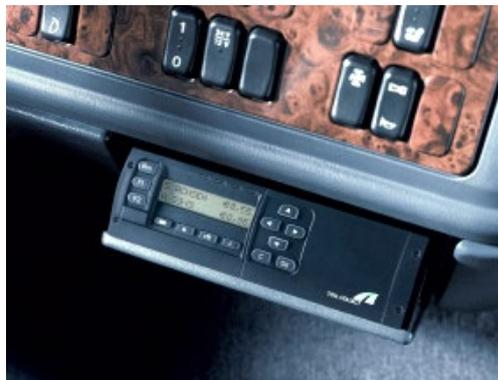
Grundig-Gerät, Einbau in einen DIN-Schacht.
